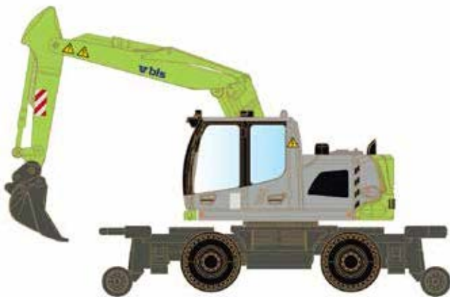
LC4269 ZWEIWEGE-BAGGER LIEBHERR A922 RAIL - BLS (CH)
