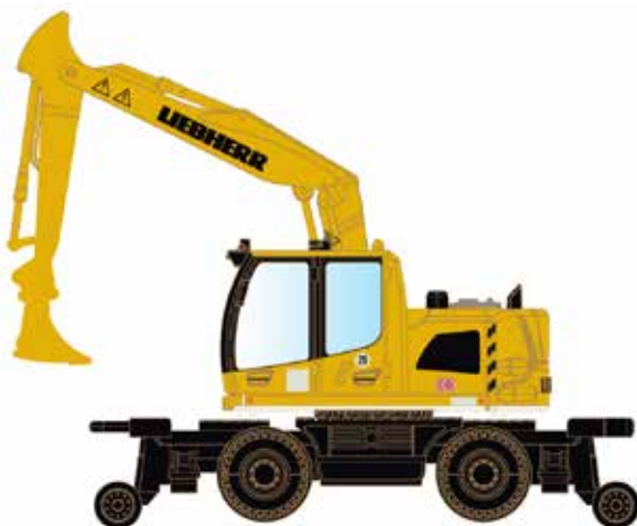
LC4270 ZWEIWEGE-BAGGER LIEBHERR A922 RAIL - DB BAHNBAU
