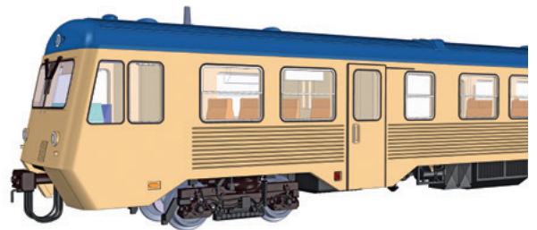
Front mit Scharfenberg-Kupplung, CAD Zeichnung
