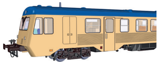
Front mit Pufferbohlen, CAD Zeichnung
