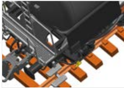
Rangierbühne und Laufgitter durchbrochen dargestellt
